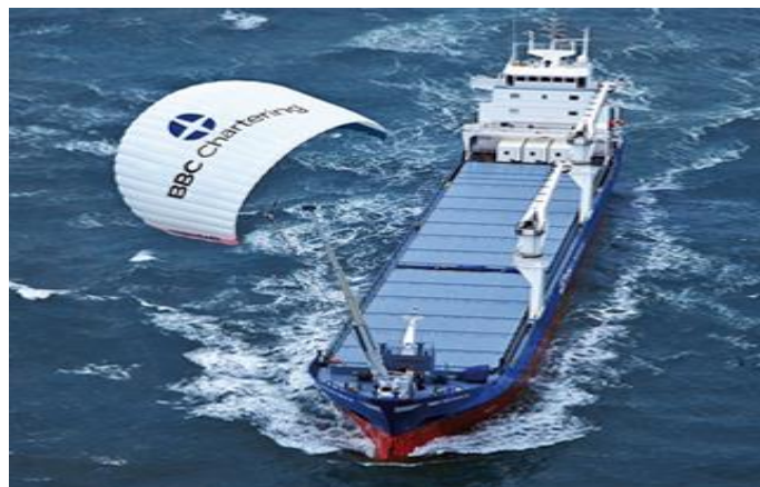
Slika 11: SkySails – pogon ladje na veter ( https://www.skysails.info/skysails-marine/skysails-antrieb-fuer-frachtschiffe (18.10.2018)).
