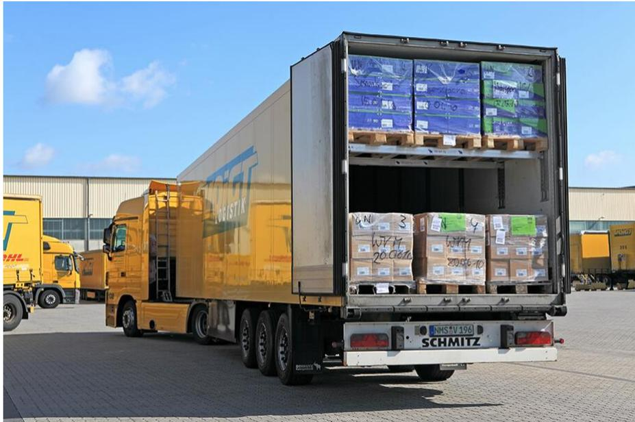
**Figura 13: Camión con carga de 2 pisos**
